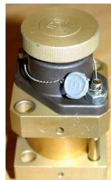
Aufgrund der wichtigen Funktion des Enddrucksicherheitsventils wird dieses vom Hersteller verplombt. Sollte dieses Ventil eine Fehlfunktion aufweisen, dann wird es nicht vor Ort repariert, sondern ausgetauscht. In vielen Fällen kann man das kaputte Ventil zum Umtausch an den Hersteller einsenden.
