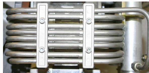
Es gibt keinen Abscheider zwischen der ersten und zweiten Stufe des Kompressors. Den Grund hierfür findest du in dem Anschnitt „Temperatur und Feuchtigkeit“. Ein dreistufiger Kompressor hat zwei Ab-
