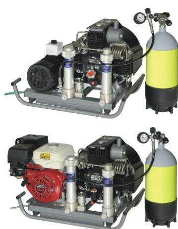
Ein Kompressor benötigt eine externe Quelle der Rotation. Das kann ein Motor sein, der bereits dreht und an welchen der Kompressor angeschlossen wird, wie z.B. das Aggregat auf einem Boot. Aber in den meisten Fällen hat ein Kompressor einen eigenen Motor. Das ist entweder ein Elektromotor oder ein Verbrennungsmotor. Die Wahl des Motors hängt von Überlegungen wie Anfälligkeit für Feuchtigkeit, das Vorhandensein einer zuverlässigen Stromquelle, Verringerung der Lärmelastigung und Mobilität ab.
