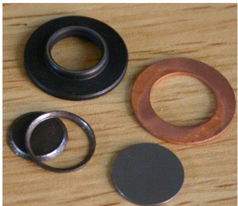
Sollte ein Auslassventil kaputt sein, dann hat sich in den meisten Fällen der Sitz durch das Ventil gefressen. Es muss sowohl das Ventil, als auch die Beilagscheibe (die beiden Teile rechts im Bild) ausgewechselt werden.
