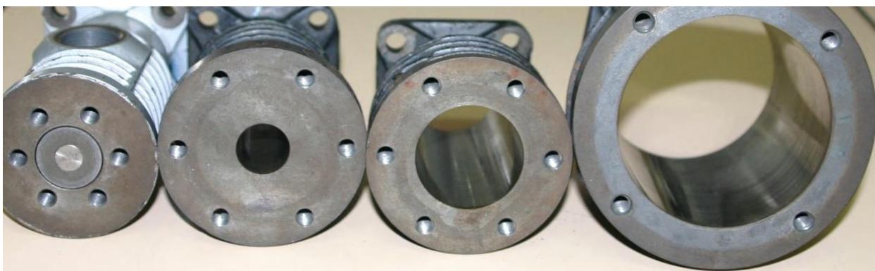
Die Größe der Zylinder variiert sehr stark. Der Kolben der vierten Stufe (links) ist nur der helle Teil in der Mitte. Vergleiche diesen Durchmesser mit der ersten Stufe rechts im Bild.
