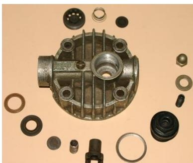
In dem Zylinderkopf befinden sich die Ventile die es der Luft ermöglichen in und aus dem Zylinder zu strömen. Das Einlassventil ist an der Innenseite und das Auslassventil an der Aussenseite (bei den meisten Kompressoren) angebracht. Einlass/innen und Auslass/aussen. Die Grösse der Ventile ist unterschiedlich, abhängig ob es sich um die erste Stufe des Kompressors oder eine spätere Stufe (und kleinere) handelt.
