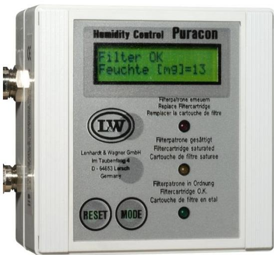
Die Aktivkohle und das Molekularsieb in einem Filter müssen in vorgegebenen Intervallen gewechselt werden. Die Einsatzdauer eines Filters kann durch die Betriebsstunden des Kompressors oder anhand der gefüllten Flaschen definiert sein. Der Kompressor kann unter verschiedenen Bedingungen laufen. Damit die Luft aus dem Kompressor die Normen für Atemluftqualität erfüllt, müssen Intervallen die sich „auf dem schlimmsten Fall“ beziehen, eingehalten werden.
