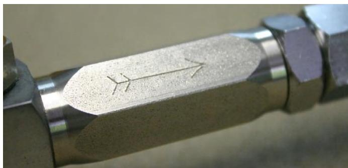
Um den Luftfluss in unerwünschte Richtungen zu vermeiden, kann ein Einwegventil an bestimmten Stellen angebracht werden. Zum Beispiel am Anschluss der Füllkonsole, um zu verhindern, dass Luft von den Tauchflaschen wieder in den Kompressor zurückströmt.
