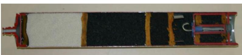
Kartusche gefüllt und dann in ein Filtergehäuse platziert. Einzelfilter werden aus Plastik oder Aluminium hergestellt. Filterkartuschen die vom Benutzer selber gefüllt werden, sind meistens aus Stahl. Jeder Hersteller hat seine eigenen Philosophie, was die Filterkartuschen betrifft. Einige erfordern die Benutzung von bereits vorgefertigten Kartuschen und andere empfehlen dem Benutzer die Filter selber mit Filtermaterial zu füllen.
