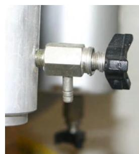
Wasser kann nicht komprimiert werden und sollte Flüssigkeit in den Zylinder eindringen, dann kann sich der Kolben nicht vollständig nach oben bewegen. Der Pleuel wird entweder die Kurbelwelle mit Gewalt nach unten oder den Zylinderkopf nach oben drücken. In beiden Fällen ist die Beschädigung des Kompressors erheblich. Aus diesem Grund sind viele Kompressoren mit einer
