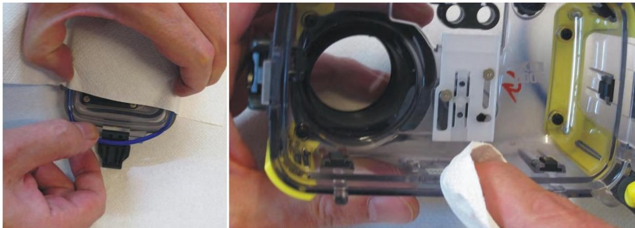
Als nächstes werden die O-Ringe entfernt. Hierfür kannst du ein Papiertuch verwenden. Übe leichten Druck auf beide Seiten des O-Rings aus und drücke den O-Ring auf eine Seite. Somit bewegt sich der O-Ring aus der Fassung und du kannst ihn mit der anderen Hand greifen. Jetzt kannst du alle Flächen reinigen die mit dem O-Ring in Kontakt sind. Dasselbe Verfahren wendest du bei der Blitzverbindung und dem Batteriekompartiment an, sollte deine Kamera über diese verfügen.
