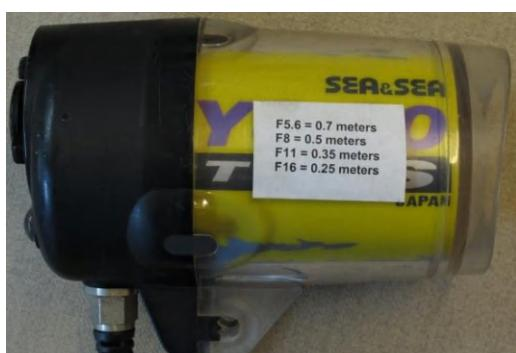
Sollte ein manueller Blitz verwendet werden, ist die Leitzahl ein fester Wert (ausser der Blitz erlaubt dir die Leitzahl einzustellen). In diesem Fall musst du die möglichen Werte für Entfernung/Blende berechnen. Da es unter Wasser schwierig ist, diese Berechnungen auszuführen, ist es eine gute Idee, eine Tabelle mit möglichen Einstellungen zu machen und diese auf deinen Tauchgang mitzunehmen.
