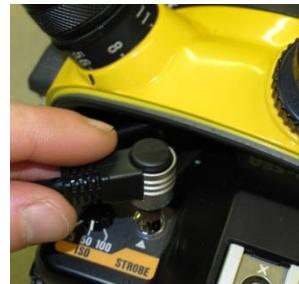
Beachte beim Einlegen der Kamera in das Gehäuse alle sich drehenden Knöpfe. Knöpfe die nur eingedrückt werden müssen, stellen normalerweise kein Problem dar. Bei Knöpfen die mit einer Drehbewegung funktionieren, müssen die Einstellungen auf dem Gehäuse denen der Kamera entsprechen. Ansonsten funktionieren sie nicht, oder du liest falsche Informationen an der Aussenseite des Gehäuses ab.
