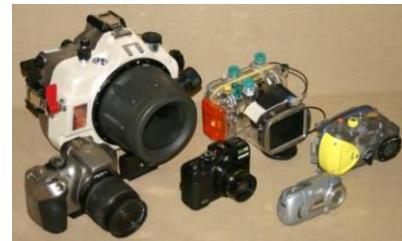
Für Kompakt- und (die meisten) Bridgekameras sind die Gehäuse eher einfach. Sie bestehen aus einem Hauptkörper und einem Gehäusedeckel. Meistens sind sie aus Plastik und die Öffnung für die Objektive ist aus Glas. Um die Klappe abzudichten, muss der grosse O-Ring vor dem Tauchgang gereinigt und gefettet werden. Der Port ist ein integraler Bestandteil des Gehäuses und erfordert keine zusätzliche Instandhaltung des Benutzers.
