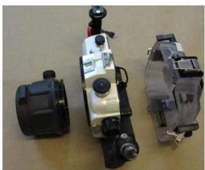
Gehäuse für SR und einige Bridgekameras bestehen aus drei Teilen. Hier kann nicht nur der hintere Teil sondern auch der Port entfernt werden. Bei dieser Konfiguration können verschiedene Objektive verwendet werden. Bei der Vorbereitung der Kamera für einen Tauchgang müssen beide O-Ringe (Gehäusedeckel und Port) gereinigt und gefettet werden.
