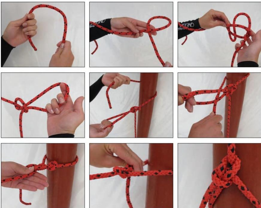
Wenn ein Seil zu kurz ist, kann man mit dem Schotstek zwei Seile (unterschiedlicher Stärken) verbinden. Zur Kontrolle, ob der Schotstek richtig geknotet wurde, achte auf die Position der kurzen Enden. Das dicke Ende sollte parallel am dicken Seil laufen. Das dünne Ende sollte in einem 90° Winkel vom Knoten wegstehen. Achte darauf, dass die erste Schlaufe mit dem dicken Seil gemacht wird.
