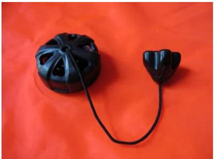
Machst du eigene Hebesäcke, kannst du dazu die Schnellablassventile von Jackets verwenden. Vielleicht musst du die Feder in dem Ventil auswechseln. Der Luftdruck oben im Hebesack hat den gleichen Druck wie das Wasser, das am niedrigsten Punkt im Hebesack ist. In einem grossen Hebesack kann der Luftdruck in einem vollständig gefüllten Hebesack erheblich grösser als der Umgebungs-
